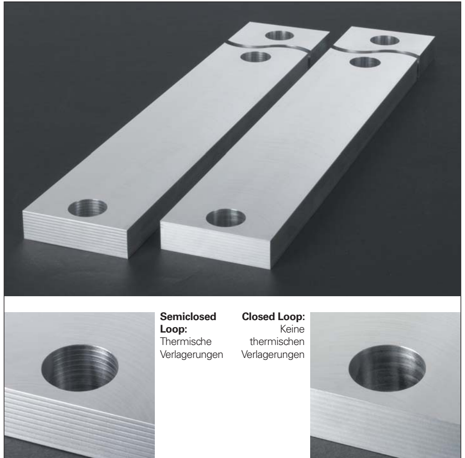
Abbildung 5 Bohr bildabweichung in der Serienfertigung
